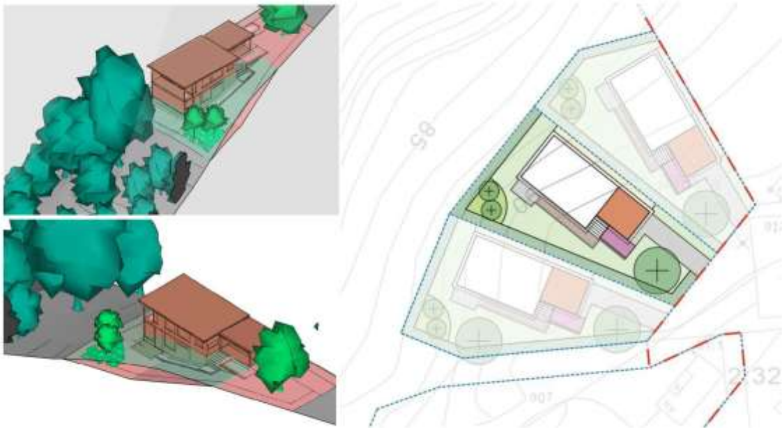
Kuva 19. Pihakaavio ja viitteelliset havainnekuvat tontin pinnoitteiden ja kasvillisuuden sijoittelusta ja määrästä. Esimerkinmukaisella jäsentelyllä saavutetaan viherkertoimen tavoitetaso.
